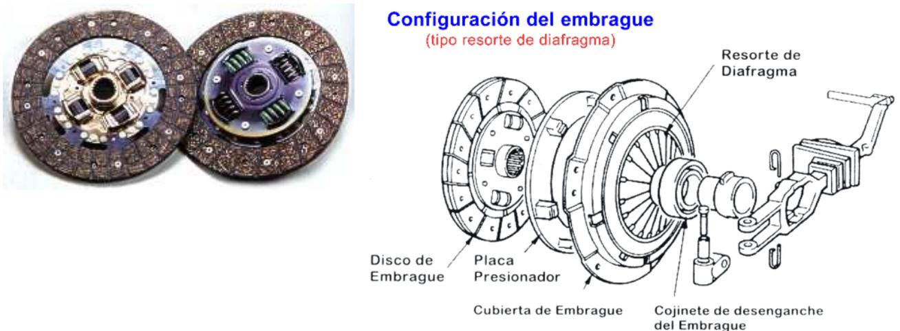
**Figura 11.5. Embrague de placa simple de uso automotriz**
