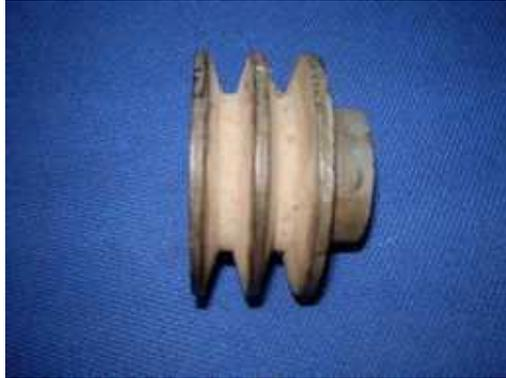
**Figura 8.2. Polea para dos bandas**
