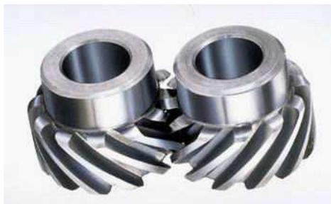
Los engranajes helicoidales acoplados deben tener el mismo ángulo de la hélice, pero el uno en sentido contrario al otro (Un piñón derecho engrana con una rueda izquierda y viceversa). Como resultado del ángulo de la hélice existe un empuje axial además de la carga, transmitiéndose ambas fuerzas a los apoyos del engrane helicoidal.
