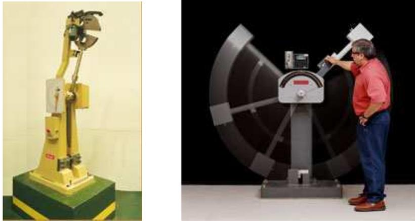
**Figura 3.7. Máquinas Charpy con diferentes capacidades**
